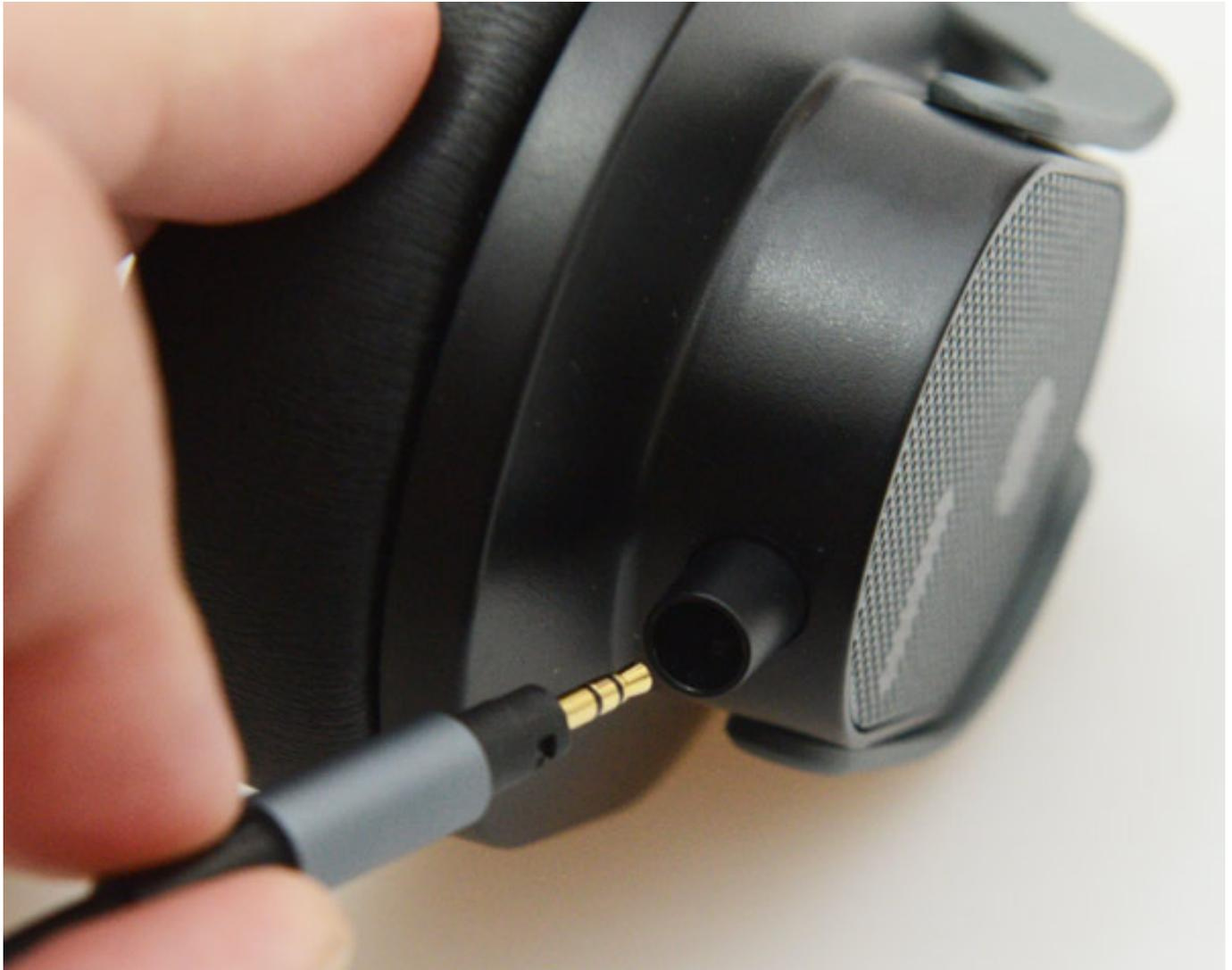
Das Audiokabel wird auf einer Seite eingesteckt und lässt sich mit einer Drehung arretieren (s. Abb. oben).
