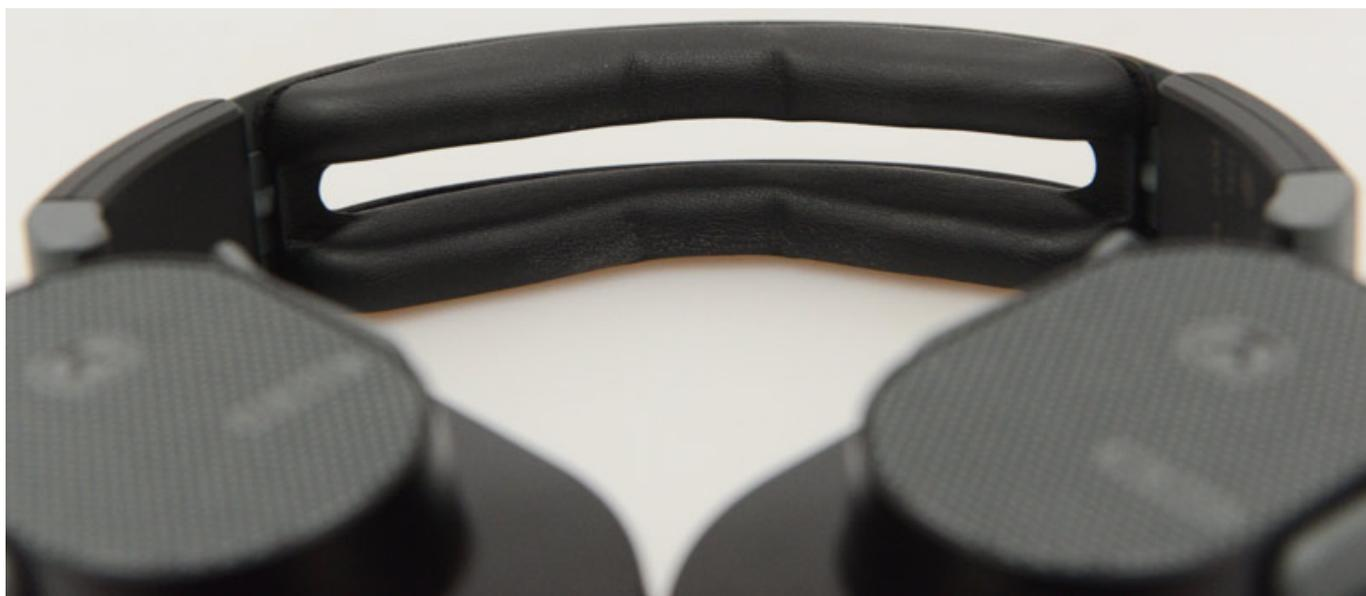
Das Kopfpolster ist in drei Segmente unterteilt und über ein Klettverschluss befestigt, so dass es sich leicht austauschen lässt. Auch die Ohrmuscheln lassen sich abnehmen und austauschen (über zwölf Punkte arretiert). Entsprechende Ersatzteile sind verfügbar.
