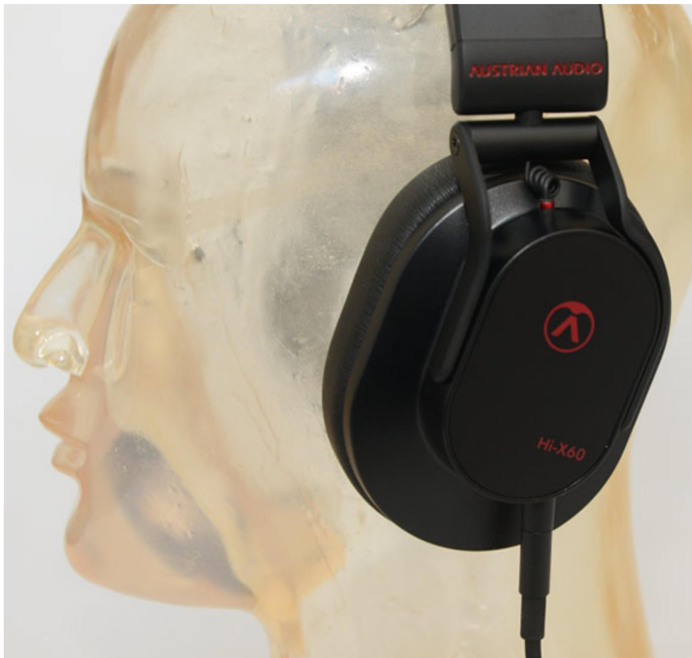
Das schwingende System, bzw. Membran, Spule und Magnetsystem sind gegenüber dem Hi-X65 identisch. Jedoch wurde der dynamische Wandler anders bedämpft. Dies notwendig wegen der geschlossenen Bauweise. Weiter kommt beim Hi-X60 im Vergleich zum akustisch offenen Hi-X65 ein zweites Rückvolumen zum Einsatz, um eine gute passive Dämpfung zu erreichen. Dies ist beim Hi-X65 wegen der offenen Bauweise nicht notwendig und wäre ja kontraproduktiv.
