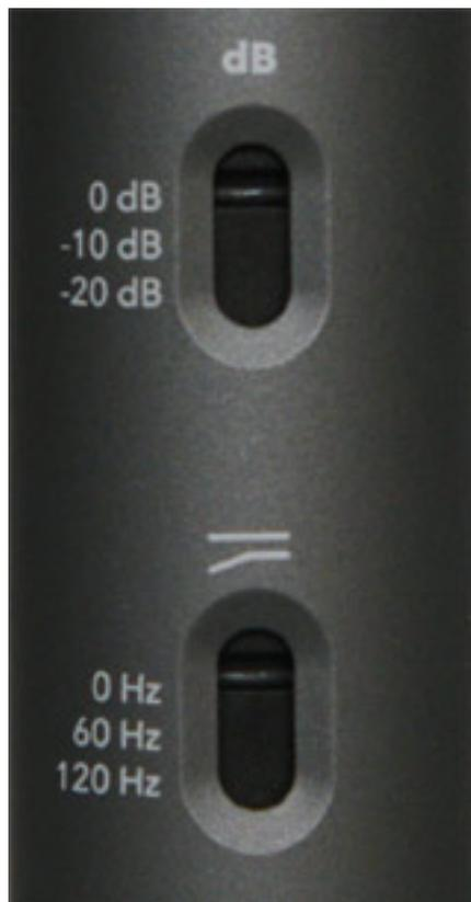
Das CC8 bietet weiter einen zuschaltbaren Hochpassfilter zweiter Ordnung mit 60 oder 120 Hz Grenzfrequenz (s. Abb. oben). Die Schalter sind wie üblich vertieft angebracht, so dass ein versehentliches Umschalten ausgeschlossen ist.
