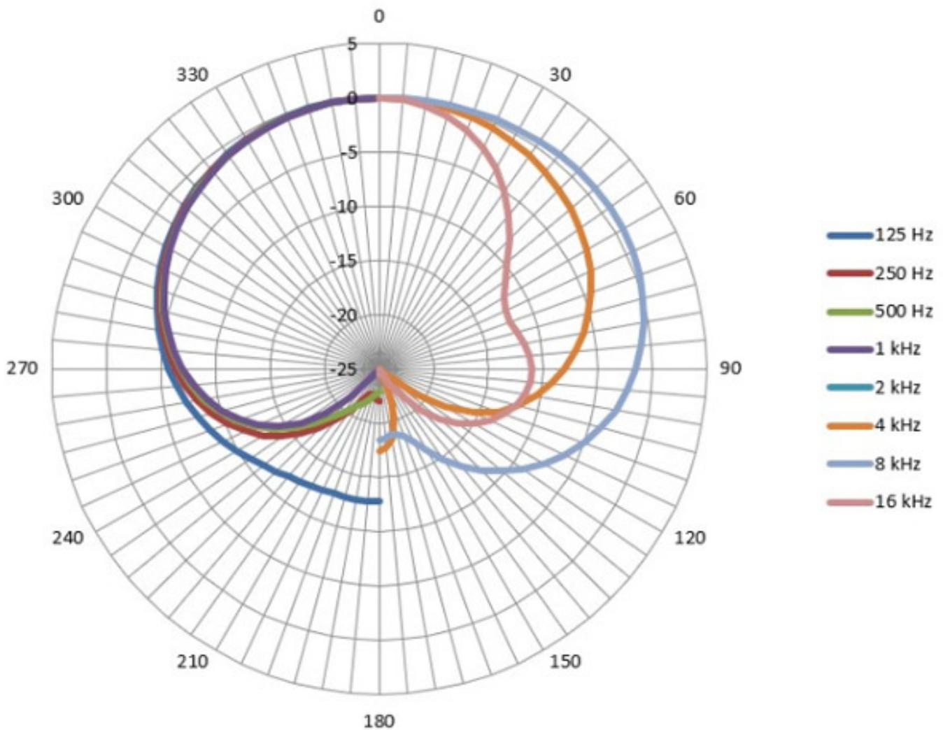
Das Polardiagramm des Herstellers verdeutlicht, wie gut die Nierenrichtcharakteristik über einen weiten Frequenzbereich realisiert werden konnte (s. Abb. oben). Das Diagramm unterstreicht ebenfalls die von uns festgestellte geringe Rückkopplungsneigung in der Praxis. Was weiter auch festgestellt werden konnte ist die sehr gute akustische Entkopplung der Kapsel vom Mikrofongehäuse.
