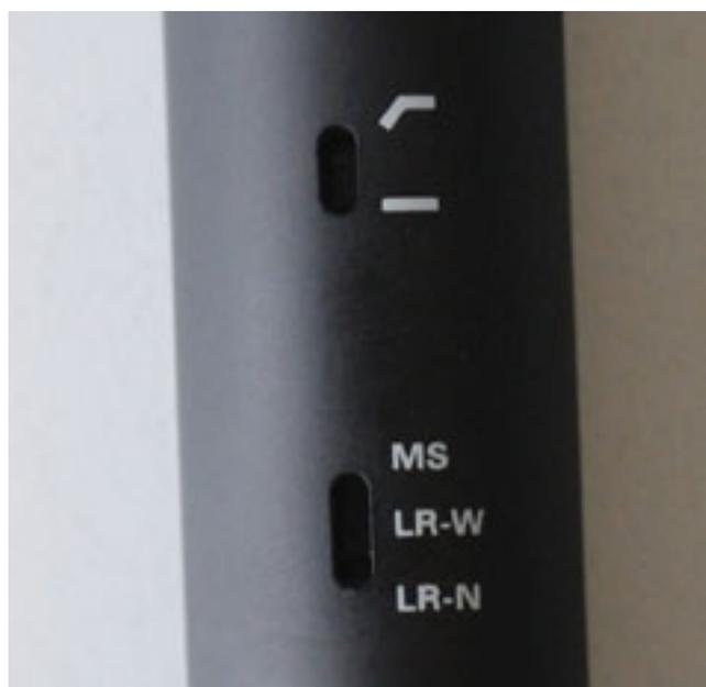
Weiter ist auch ein Tiefpassfilter mit einer Grenzfrequenz von 80 Hz und einer Steilheit von 12 dB/Okt. über einen weiteren Miniatorschalter aktivierbar.
