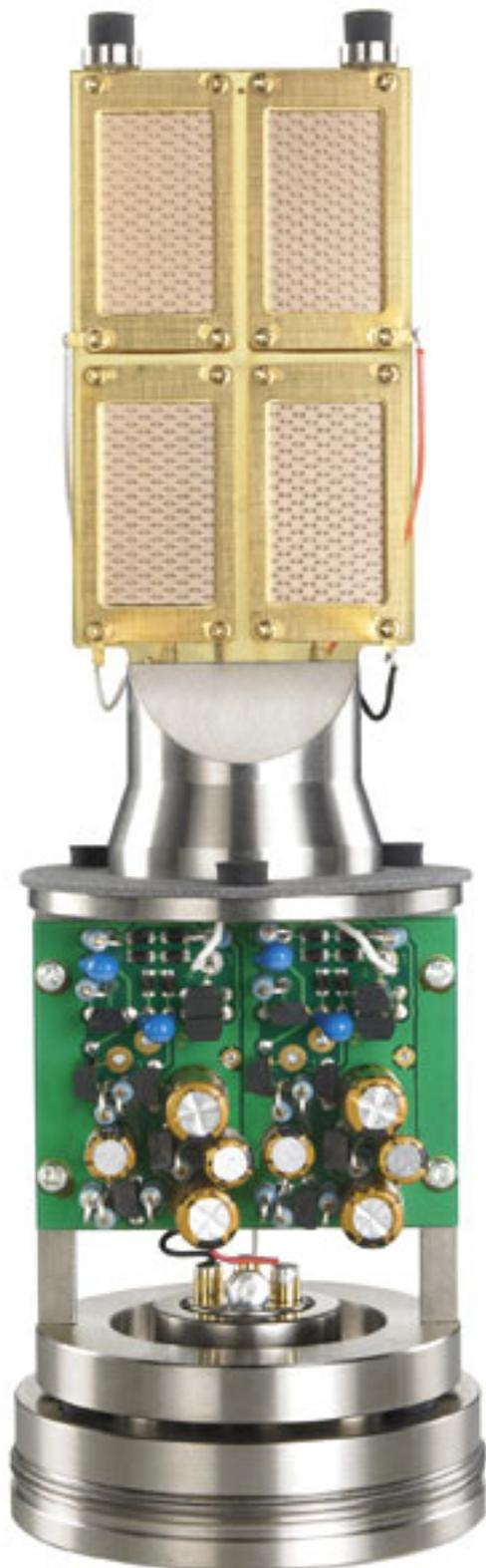
Der innere Mikrofonaufbau ist von der äußeren Hülle über Gummiteile (oben an dem Array und unten über der Verstärkerplatine) akustisch entkoppelt. Der technische Aufbau ist sehr puristisch denn sowohl ein schaltbares Dämpfungsglied als auch ein zuschaltbares Trittschallfilter sucht man vergebens. All diese Maßnahmen tragen
