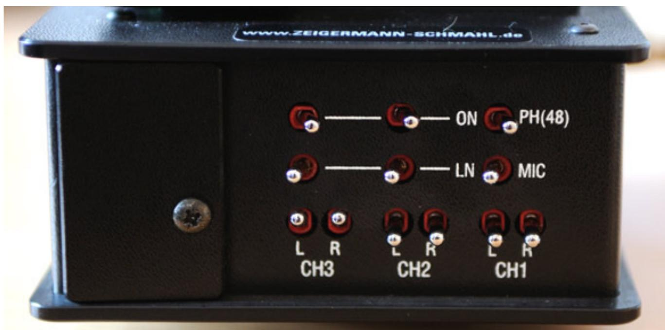
Auf der Rückseite befindet sich neben dem Anschluss für ein optionalen Batteriepack eine Reihe von Miniatorschaltern. Pro Kanal kann eine 48-Volt-Phantomspeisung aufgeschaltet werden. Eine Pegelanpassung (Line, Mic) ist ebenfalls wählbar. Darunter befinden sich die Routingschalter. Die drei Eingänge sind jeweils auf L, R, L+R oder auf keinen der Ausgänge schaltbar.
