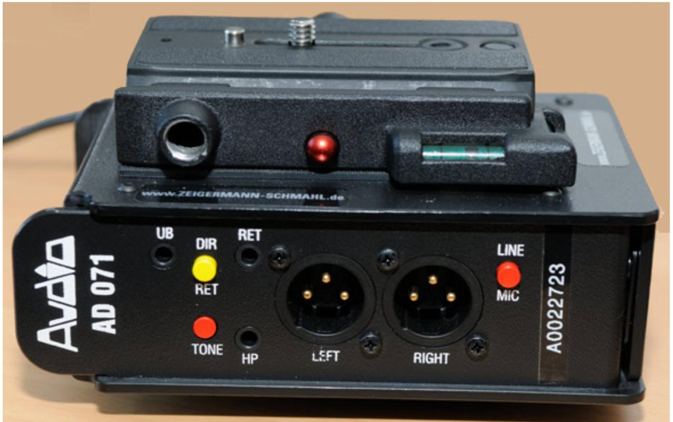
Die rechte Seite des AD071 befinden sich mehrere Ein- und Ausgänge. Die als UB bezeichnete 3,5 mm Stereoklinkenbuchse ist ein Stereoausgang für eine Filmkamera. Dieser Ausgang steht parallel zu den XLR-Ausgängen zur Verfügung. Der Pegel liegt auf Mikrofonpegel-Niveau von ca. -40 dBu relativ zum Master-Ausgang.
