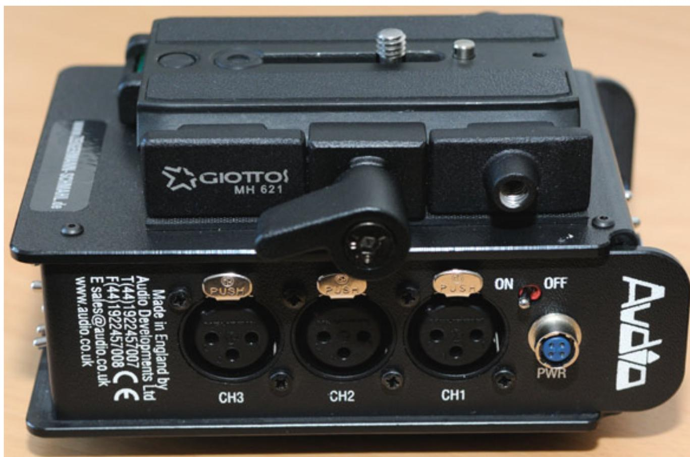
Auf der linken Seite befinden sich die drei XLR-Eingänge, der Hirose-Anschluss für eine externe Stromversorgung sowie ein On/Off-Schalter.
