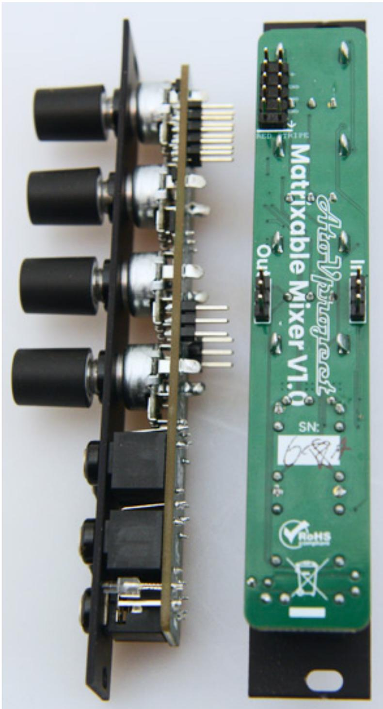
Es lassen sich aber mehrere Mischer kaskadieren. Die Kaskadierung erfolgt über ein dreiadriges Kabel. Hierzu sind auf den Modulen jeweils eine In- und Out-Pfostenleiste (s. Abb. oben) auf der Platinen-Rückseite vorhanden. Es liegen dem Duo zwei Verbindungskabel für die Modulverbindung bei. Für die Kaskadierung muss man das Out-Port des ersten mit dem In-Port des zweiten Mischers verbinden. Der Betriebsstrom beträgt 10 mA (+12 V), bzw. 8 mA Peak (-12 V) pro Modul.
