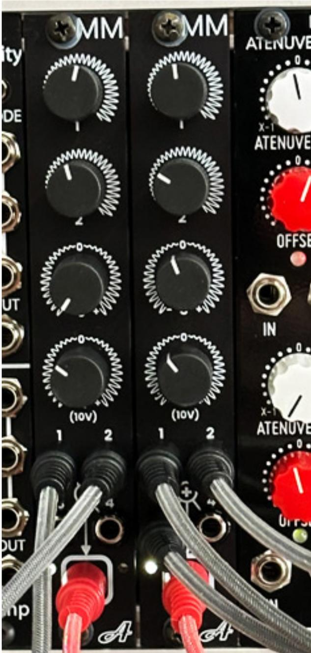
Der Mischer ist eine ideale Kombination aus Abschwächer (In 1/2), Verstärker/Inverter (In 3/4) sowie Summen-Spannungsoffset-Anpassung (über Regler 4 ohne Nutzung der Buchse 4). Von solchen Modulen kann man nicht genug haben. Häufig lassen sich steuerspannungsabhängige Parameter nicht entsprechend am Modul selbst einstellen. Ein klassisches Beispiel sind Wavetable-Ansteuerungen. Diese sind häufig viel zu groß in der Auslenkung und klingen
