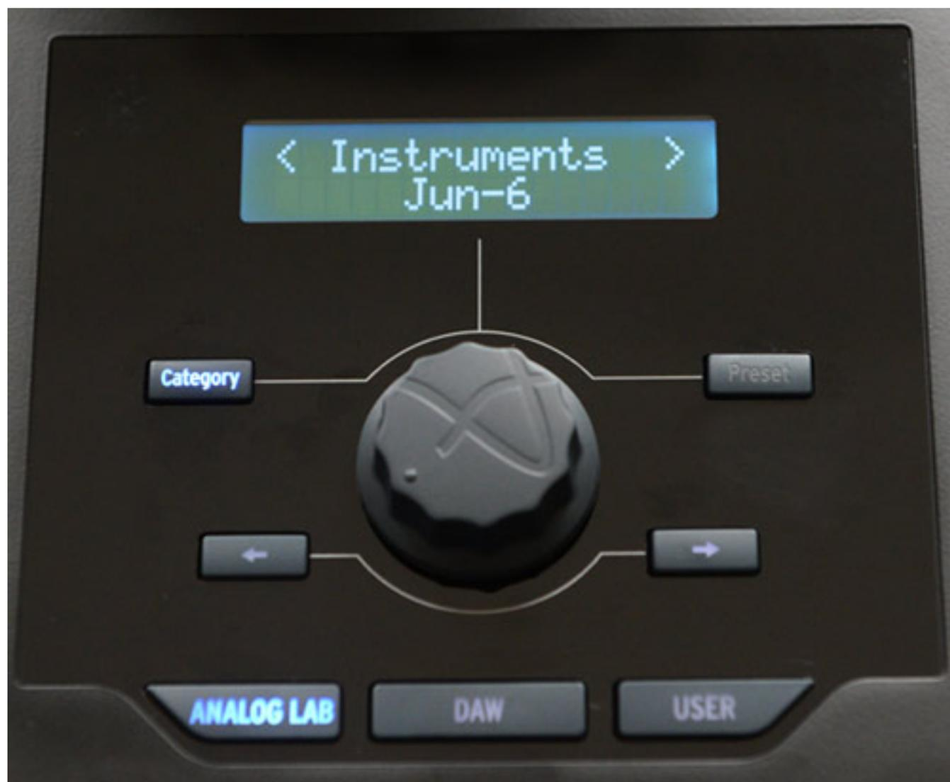
In der Mitte befindet sich eine zentrale Sektion mit Druck-Drehgeber, die sich für die Instrument/Preset-Anwahl in Analog Lab (dazu später mehr) nutzen lässt. Das monochrome LC-Display vermag 32 Zeichen darzustellen. Über den Drehgeber lässt sich im DAW-Betrieb der Abspielposition/Play Cursor verändern. Im User-Modus lassen sich mit der Kategorie/Preset Tasten in Verbindung mit dem Drehgeber Presets Bänke und Presets (Programm Change) beliebiger MIDI-Instrumente selektieren.
