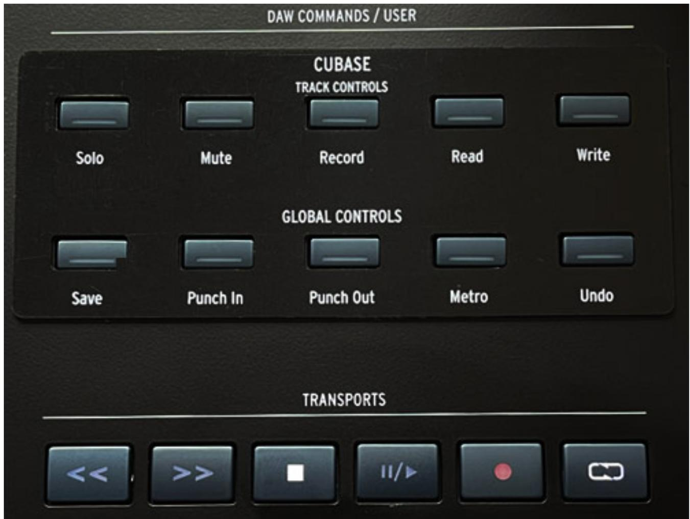
Rechts daneben befindet sich die Sektion für die DAW-Steuerung (s. Abb. oben). Für die wichtigsten DAWs gibt es hier Magnet-Auflagemasken mit den entsprechenden Beschriftungen. Oben hier in der Abbildung exemplarisch die für Nuendo/Cubase.
