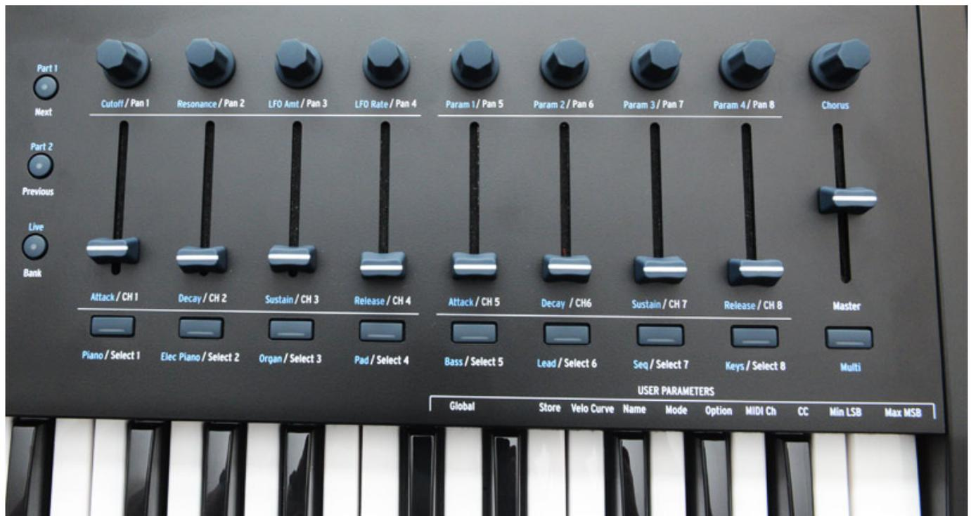
Der ganze rechte Teil bietet acht Selektionstaster, Fader und Endlos-Drehgeber, sowie ein neunten für den Master-Kanalzug. Diese Sektion kann zur DAW Steuerung, Parameter-Steuerung eines Presets oder zur Anwender-definierten Steuerung beliebiger MIDI-Parameter genutzt werden. Es stehen hier mehrere Speicherbänke zur Verfügung. Im DAW-Modus lässt sich mit den Tasten der aktuell selektierte Kanal auswählen.
