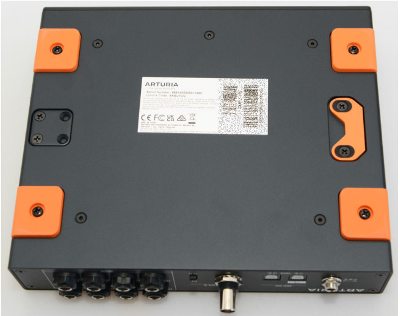
Auch Winkel zum Montieren in ein 19"-Rack befinden sich im Lieferumfang. Je ein Rack-Winkel und eine Verbindungsplatte sowie vier Schrauben befinden sich auf der Unterseite des Gerätes befestigt. Winkel und Verbindungsplatte lassen sich von der Rückseite losschrauben. Damit können zwei AudioFuse X8-Interfaces mit je einer halben 19-Zoll-Breite zu einer 19-Zoll-breiten Einheit zusammenfügen und im Rack befestigt werden.
