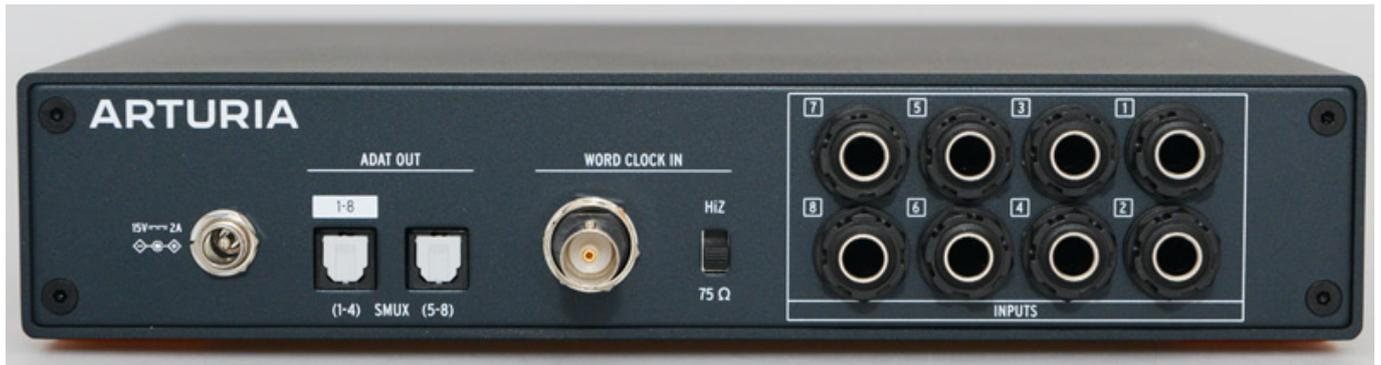
Werfen wir nun einmal einen Blick auf die Geräterückseite. Diese ist im Prinzip beim X8 IN und X8 OUT identisch nur das eben Ein- oder Ausgänge bereitstehen. Der Hohlstecker-Anschluss für die Spannungsversorgung ist über eine Verschraubung arretierbar. Das Netzteil lässt sich im Spannungsbereich von 100 bis 240 Volt mit einer Netzfrequenz von 50 oder 60 Hz betreiben.
