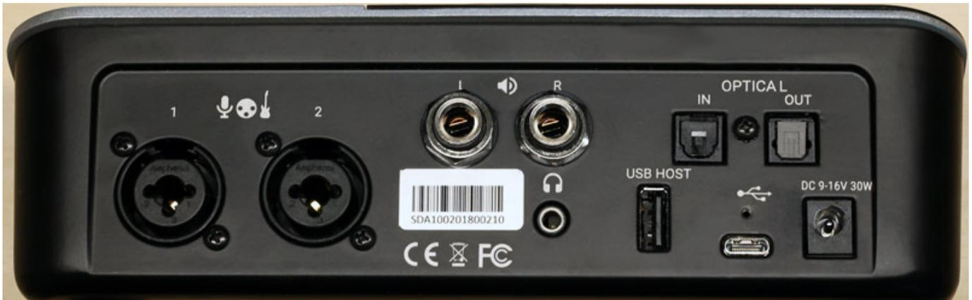
Auf der Rückseite befinden sich zwei analoge Eingänge für Mikrofon, Line oder Instrument in Form von XLR-Kombo-Buchsen sowie zwei analoge Ausgänge, die als symmetrische 6,3mm Klinkenbuchsen ausgelegt sind. Unterhalb der Line-Ausgänge versteckt sich ein Kopfhörerausgang mit 3,5mm-Klinkenbuchse. Dieser lässt sich unabhängig vom frontseitig Kopfhörerausgang einsetzen. Digitale Audiosignale werden durch eine ADAT-Schnittstelle realisiert, die sich auch für S/PDIF-Signale eignet.
