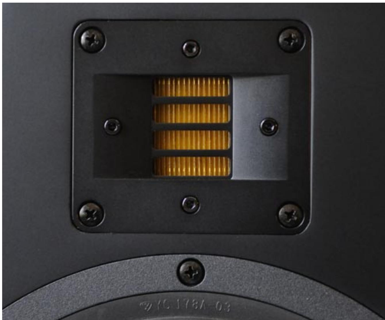
Auch hier ist eine Weiterentwicklung eingeflossen. Der eingesetzte X-ART-Treiber vermag auch Signale mit Frequenzen von bis zu 50 kHz wiedergeben. Der Treiber hat gegenüber traditionell aufgebauten Hochtönern einen bemerkenswerten Wirkungsgrad von 96 dB/W/m. Dieser Treiber kommt in der gesamten AX-Serie zum Einsatz.
