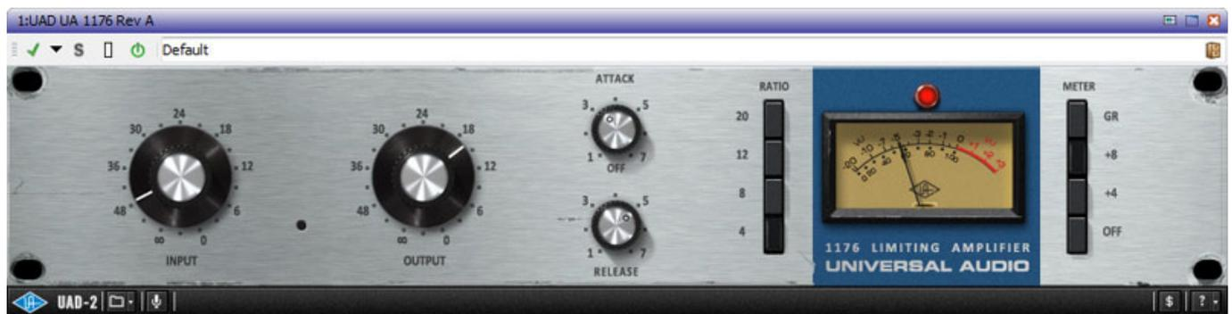
Der 1176 Rev. A (s. Abb. oben) entspricht der ersten Version des 1176 aus dem Jahre 1967 mit den Seriennummern 011 bis 125. Man erkennt schon das er nicht lange am Markt war und wurde bald durch die Rev. AB und B (bis Seriennummer 1078) abgelöst. Er hat eine roten Indikator als Betriebsanzeige und wird wegen seinem Frontplatten-Design manchmal als "Bluestripe" bezeichnet. Er ist definitiv von allen Plug-Ins am ursprünglichsten.
