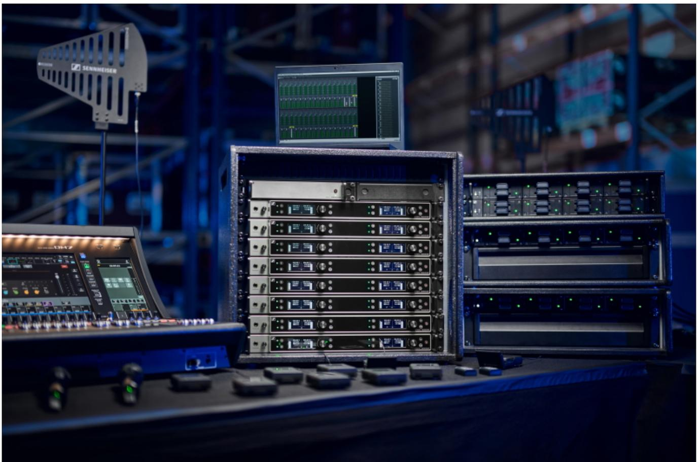
Sobald die Empfänger eingerichtet sind, kann über einen EW-DX EM 4 Dante ein schneller Frequenzscan durchgeführt werden. Dieser verteilt automatisch freie Frequenzen auf alle verbundenen Empfänger, einschließlich der Empfänger EW-DX EM 2 und EW-DX EM 2 Dante, und spart so Zeit und Aufwand. Auch spezifische Frequenzlisten können in den Empfänger geladen werden.
