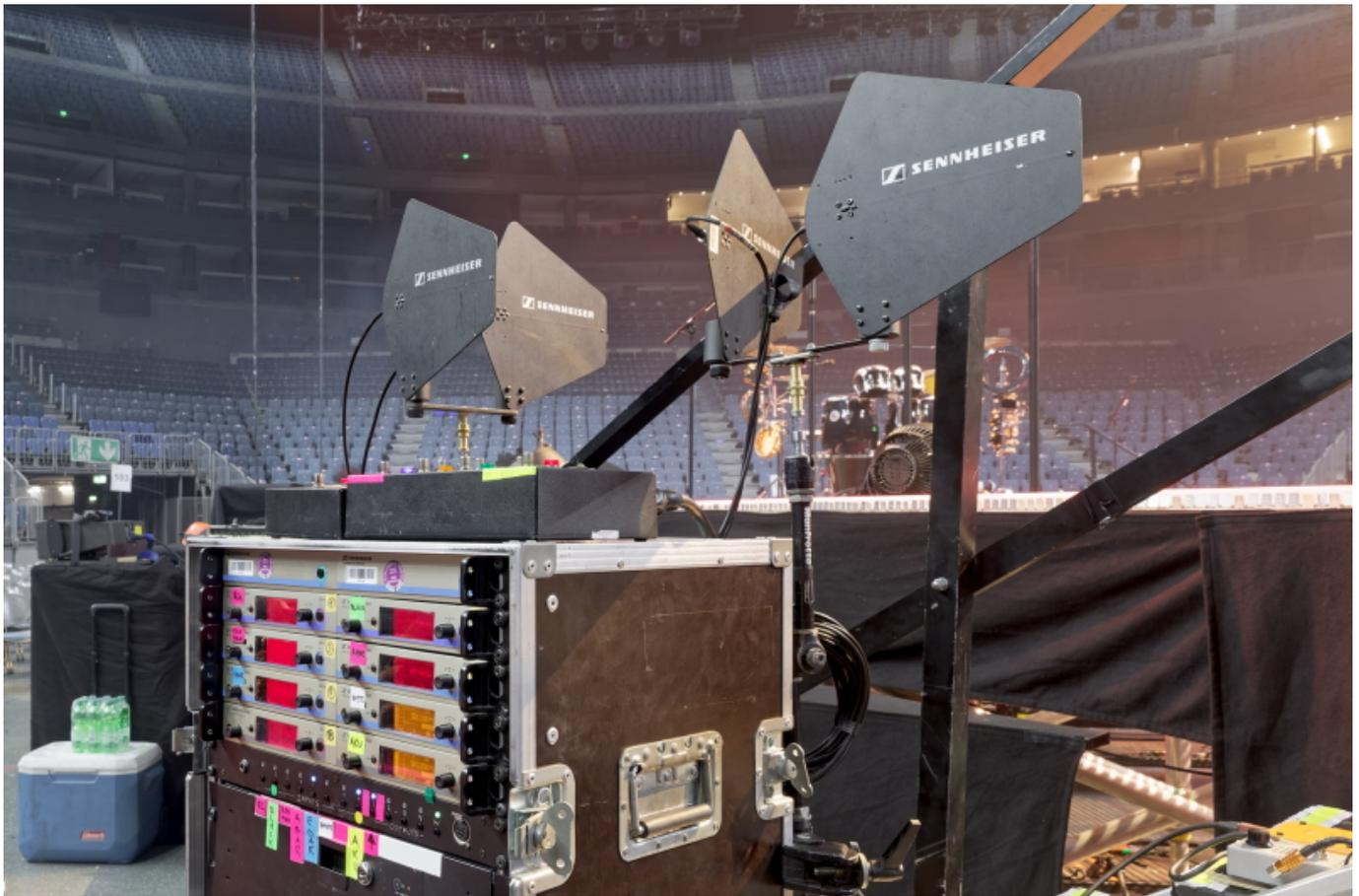
Gitarrist Carl Carlton hatte zwei Sennheiser-Empfänger EM 500 im Einsatz, die im E-Band betrieben wurden. Ein Empfänger des gleichen Typs wurde in Köln bei 824,1 MHz für das Instrument des Saxofonisten genutzt. Bassist Ken Taylor, der nach einem unglücklichen Sturz bei einer Probe zu Beginn des Jahres 2020 wieder vollständig genesen ist, hatte sein Instrument mit einem Taschensender SK 500 G3 verbunden, dessen Signal von einem EM 500 G3 auf einer Frequenz von 823,5 MHz empfangen wurde.
