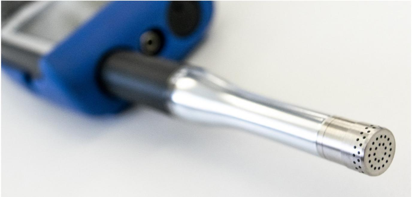
Das neue Messmikrofon M2340 ist eine Weiterentwicklung des M2230, kompatibel mit dem XL2 und ist ebenfalls ein Klasse 1 Messmikrofon. Darüber hinaus verfügt das M2340 über eine Selbsttest-Funktion und verbraucht deutlich weniger Strom als das M2230.
