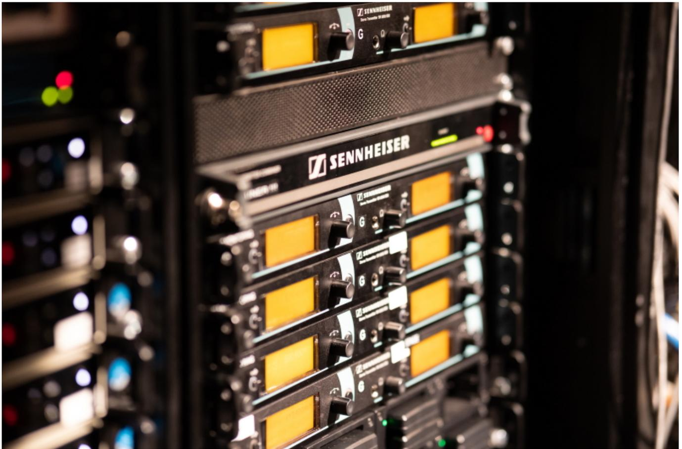
Ergänzt wurde die IEM-Ausstattung durch einen weiteren SR 2050 IEM-Sender am Monitorplatz, der die Signale für die Stage-Crew sowie den Monitor-Engineer lieferte. Abgerundet wurde die analoge Wireless-Technik durch zwei Sennheiser EM 300 G4 Empfänger, denen der Handsender des Stage-Managers und ein mobiles Talkback-Mikro für die Crew zugewiesen waren.
