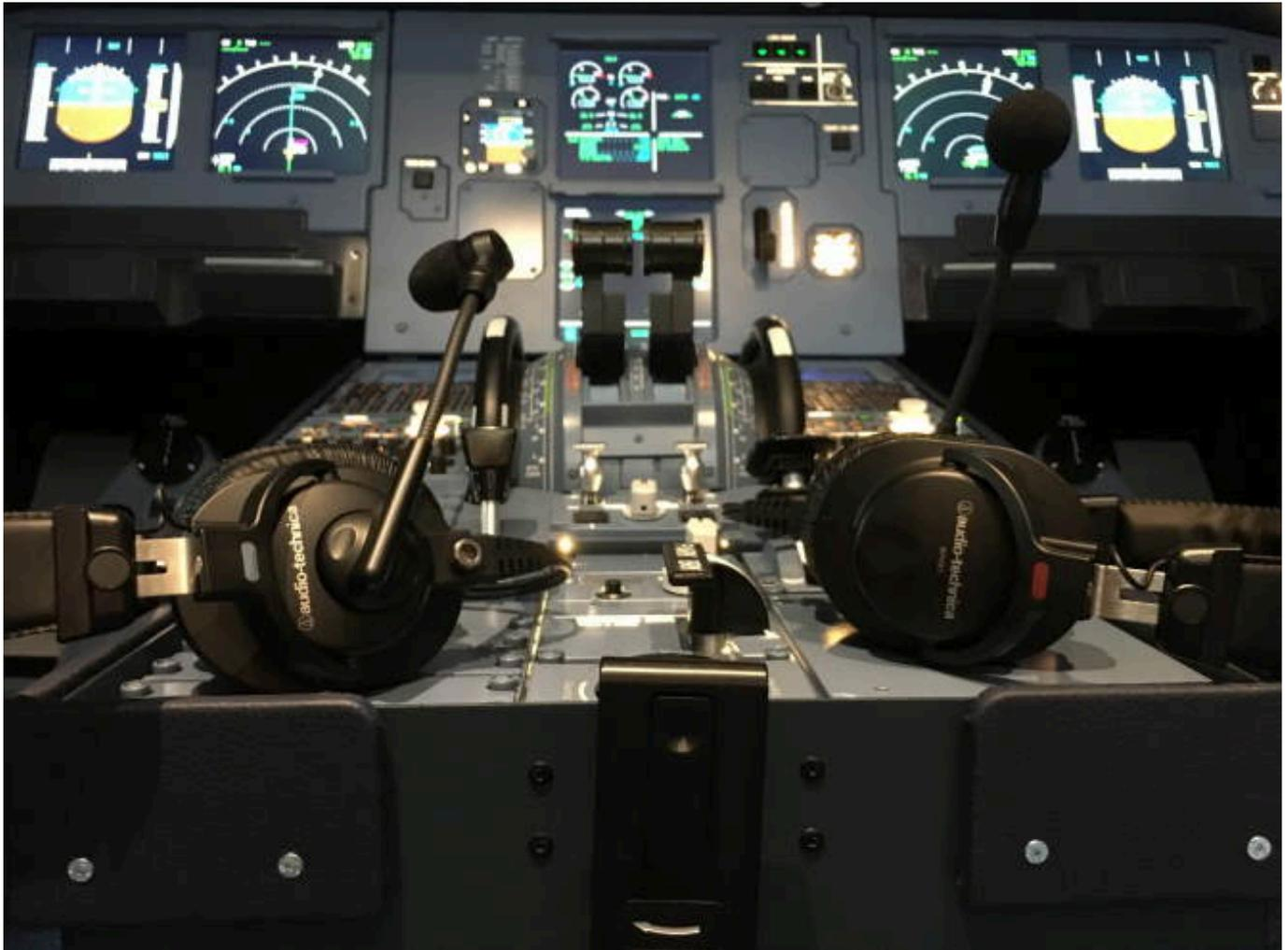
Das BPHS1 sieht aus und fühlt sich an wie ein konventionelles Pilotenheadset. Zudem lässt sich das Mikrophon und Anschlusskabel links wie auch rechts tragen. Das ist für die Simulatoren von Vorteil, da der Anschluss für den Flugkapitän links liegt, der für den Ersten Offizier rechts. Die flexible Positionierung des Mikrofons und der Anschlusskabel verhindert somit, dass Kabel vor oder hinter dem Kopf entlanggeführt werden müssen.
