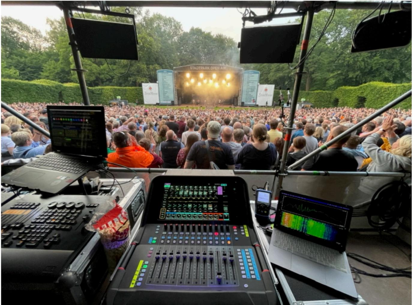
Zur vollständigen Kontrolle des Avantis Solo von Allen & Heath dient ein Tablet mit der Avantis Director Software. In das Steuernetzwerk eingebunden, kann Hof damit den Status des Dante-Netzwerks abfragen und kann bei Bedarf eine schnelle Fehleranalyse betreiben. Zudem kann Hof das Avantis Solo auch abseits des FOH-Platzes in allen Belangen fernsteuern.
