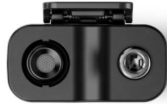
Wird ein Mobiltelefon zur Aufnahme von Videos verwendet, wird der Empfänger des Profile Wireless mit dem mitgelieferten Lightning- oder Mini-USB-Adapter verbunden. Dank eines Gyrosensors dreht sich das Display des Empfängers automatisch um 180°, um stets gut lesbar zu bleiben.
