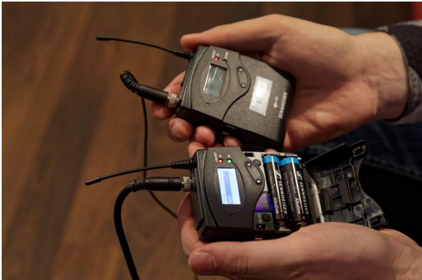
Das Team von Bullshit TV verwendet drei Sennheiser ew 112P G4-E UHF-Sets, die im E-Band (anmelde- und kostenfrei nutzbarer Bereich zwischen 823 und 865 MHz) betrieben werden. Die robusten All-in-One-Funksysteme lassen sich flexibel bei Außen- wie Innenaufnahmen einsetzen und überzeugen mit einem hervorragenden Sound in Broadcast-Qualität (Audioübertragungsbereich von 25 Hz bis 18 kHz).
