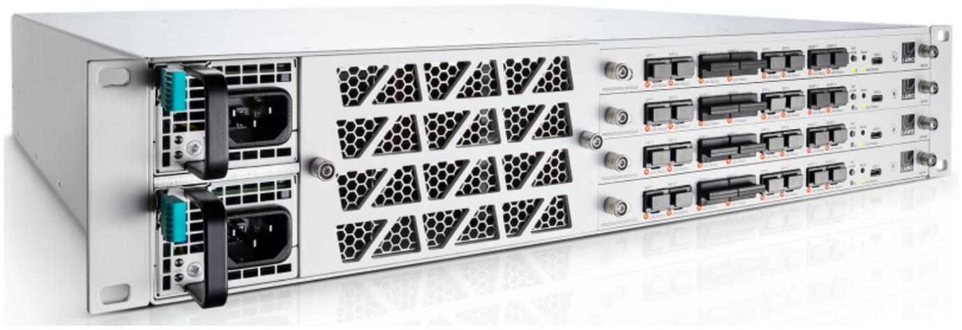
Ebenfalls zu sehen ist die HOME-native .edge Hyper-Density SDI/IP Conversion and Routing Platform. Jede der bis zu vier rückseitigen I/O-Platinen bietet 48 HD-BNC-Anschlüsse für SD/HD/3G/UHD-SDI-Schnittstellen, was 192 SDI/IP-Konvertierungen je 2HE erlaubt.
