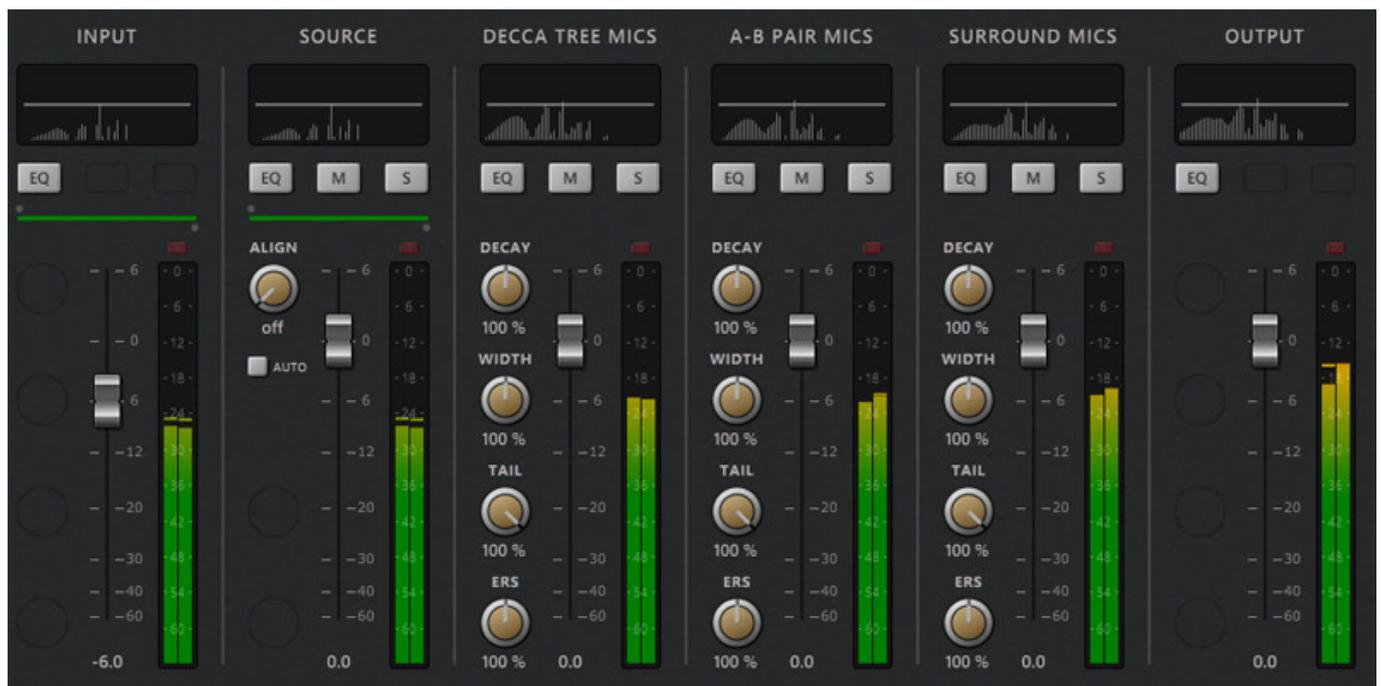
Kanalzügen für Ein- und Ausgang, Quellensignal sowie der drei Mikrofongruppen. Bei der Quelle lässt sich eine Verzögerung manuell einstellen oder beim Anklicken von Auto eben automatisch kompensieren. Bei den drei Mikrofonkanälen kann man neben Early Reflections und Tail-Pegel, die Abklingzeit sowie die Stereobreite relativ auf den Standardwert in Prozent einstellen. Über den Fader lässt sich der Pegelanteil des Mikrofons justieren.
