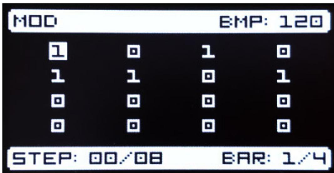
Ein weiterer sehr interessanter Modulations-Modus ist der Trigger-Modus. Für jeden Step kann man durch Drücken des entsprechenden Drehgebers ein Triggerimpuls aktivieren oder deaktivieren und somit lassen sich unter anderem auch Drum- und Percussion-Module triggern. Die Möglichkeiten sind durch die eingestellte
