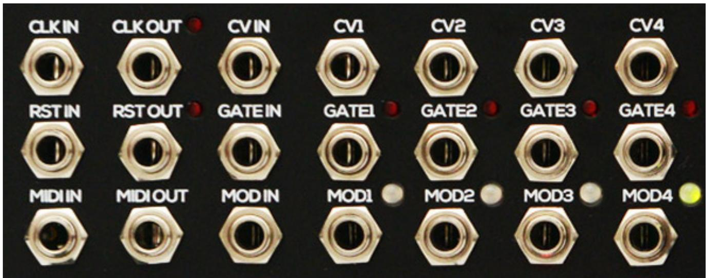
Werfen wir als erstes einmal einen Blick auf die Anschlüsse. Rechts befinden sich die CV-, Gate- und Modulationsspannungsausgänge der vier Spuren. Daneben sind jeweils ein CV-, Gate und Modulations-Eingang angeordnet. Der Black Sequencer verfügt über Clock, Reset und auch MIDI-Ein- und Ausgänge - ebenfalls als 3,5-mm-Klinkenbuchsen ausgeführt.
