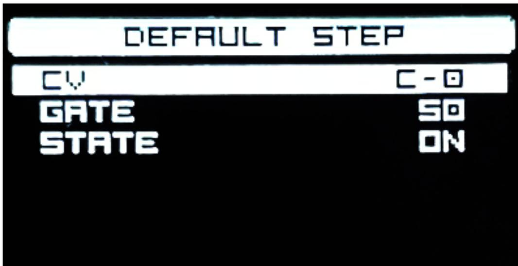
In einem Dialog lassen sich auch Standardeinstellungen eines Steps, als da wären Note und Gate-Länge, definieren (s. Abb. oben).
