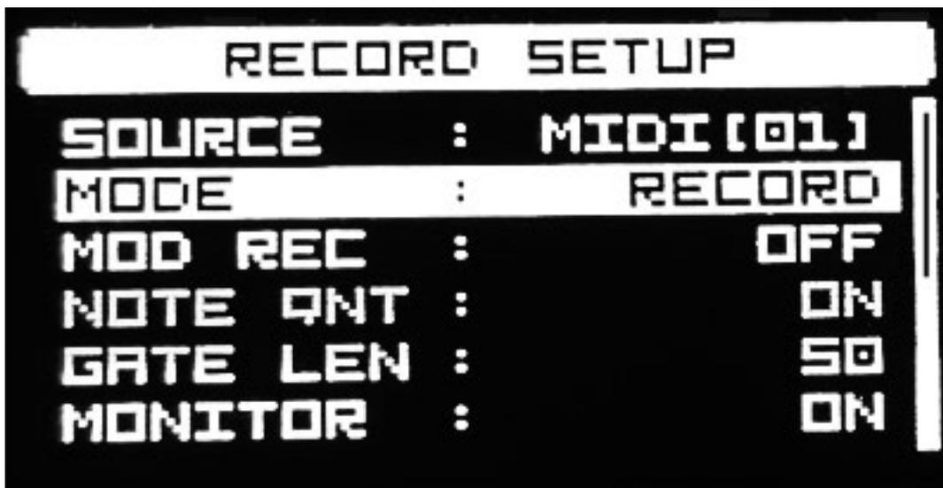
Seit der Firmware 1.02 sind auch Recording-Funktionen hinzugekommen. Über die Tastenkombination Setup + Record-Button lässt sich der Dialog für die Recording-
