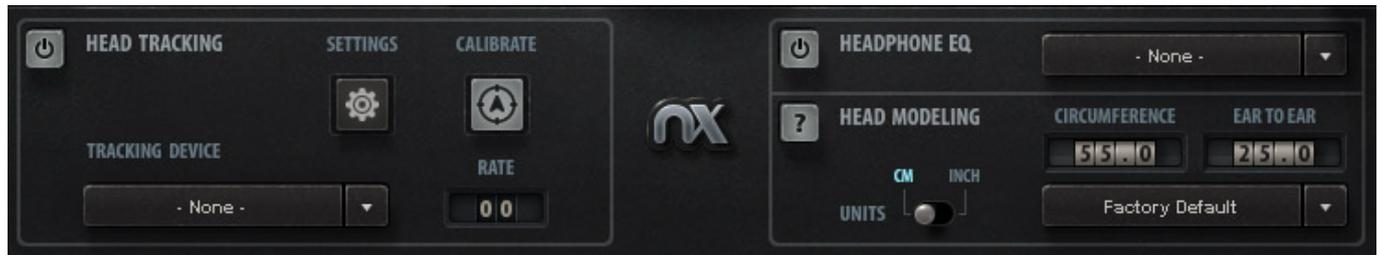
Das Headtracking kann man beim NX Headtracker über zwei verschiedenen Wege realisieren. Waves bietet mit dem Waves NX HeadTracker ein Headtracking-Sensor an, der oben am Kopfhörerbügel befestigt wird und die Kopfposition mittels Bluetooth an die Headtracker-Software übermittelt.
