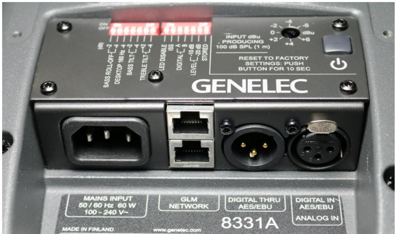
Rechts daneben befinden sich der Ein-/Ausschalter sowie ein Poti zur Anpassung der Eingangsempfindlichkeit von +/- 6 dBu. Ein kleines, aber wichtiges Detail: Wird der Ein-/Ausschalter länger als zehn Sekunden gedrückt, werden alle DSP-Einstellungen des 8331A auf die Werkeinstellungen zurückgesetzt.
