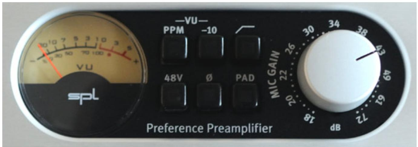
SPL bietet innerhalb der Analog Elemental Series zwei verschiedene Mikrofonvorverstärker an. Der Preference Preamp verfügt über eine zuschaltbare 48-Volt-Phantomspeisung (maximal 14 mA), Phasenumkehrung, 20-dB-Dämpfung, 75-Hz-Hochpass sowie Meterumschaltung (VU/PPM und -10 dB). Das Gain lässt sich über einen Regler von 18 bis 72 dB einstellen.
