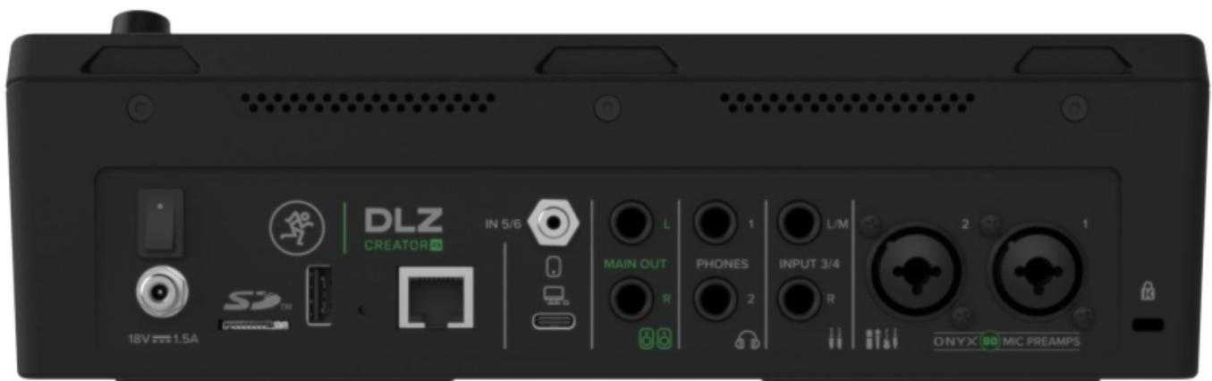
Wiedergabe- und Aufnahmegeräte können über zwei 1/4-Zoll-Klinken-Eingänge, einem Stereo-Smartphone-Eingang (3,5 mm Klinke) sowie Bluetooth- und USB-Eingängen angebunden werden. Über die integrierte USB-C-Schnittstelle werden Mehrspuraufnahmen auf einen Computer oder direkt auf ein externes Flash-Laufwerk oder den integrierten SD-Kartensteckplatz realisiert. Und über NDI kann sogar eine Verbindung zu professionellen Video-Setups hergestellt werden.
