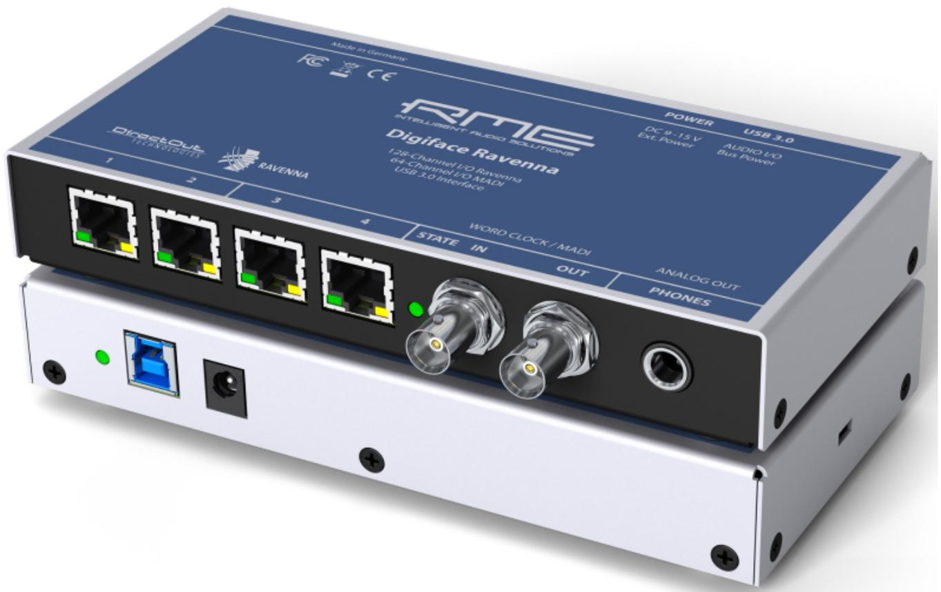
RME und DirectOut präsentieren das neue Digiface Ravenna. Das mobile Audio Interface basiert auf dem bewährten Digiface Dante, verfügt aber über ein von DirectOut entwickeltes RAVENNA Modul. Das Gerät ermöglicht die Übertragung von insgesamt 128 Audiokanälen aus RAVENNA und optional MADI über einen einzigen USB 3.0-Anschluss. RME erweitert damit seine Digiface Serie um ein leistungsfähiges RAVENNA Modell für den USB- und Standalone-Betrieb.
