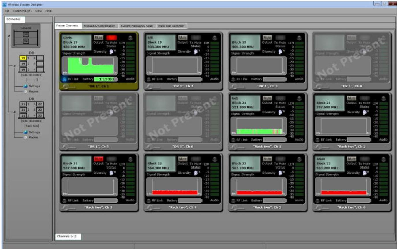
Sehr hilfreich, schnell und gründlich ist die Software bei der Frequenzkoordination. Scan-Daten können importiert und für die Koordination verwendet werden. Werden einzelne Träger manuell verschoben, erfolgt sofort eine Neuberechnung und Anzeige der Kompatibilität. Verschiedene Funktionen zum Scannen des Spektrums und zur Aufzeichnung von Begehungstests erleichtern die Anpassung an den jeweiligen Standort.
