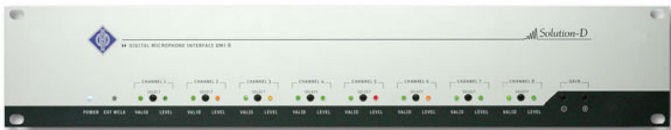
Auch diese Interfaces lassen sich alle kaskadieren, um so bis zu 64 Kanäle mit einem System kontrollieren zu können. Mit einem Zusatzmodul ist es auch via Ethernet kontrollierbar.
