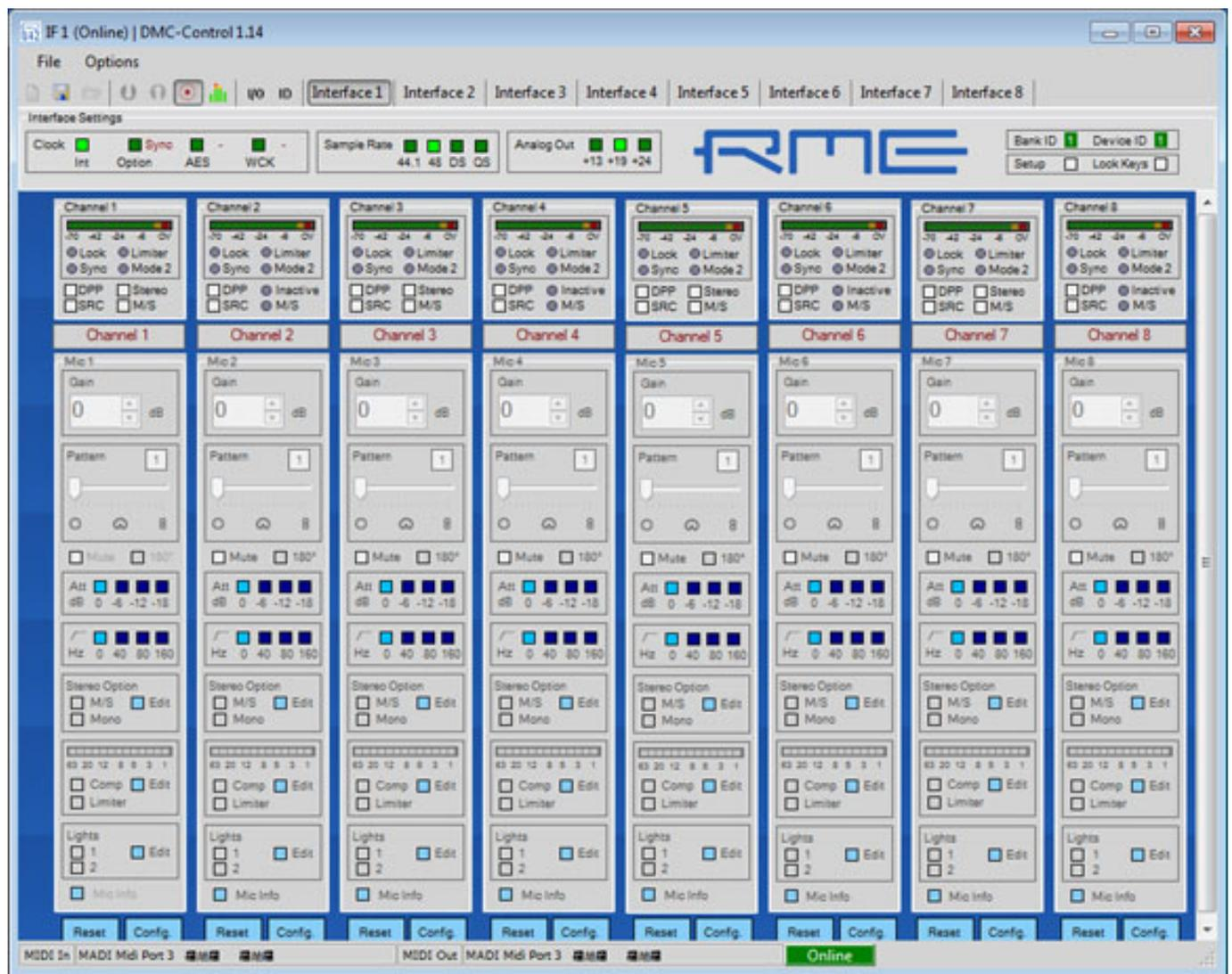
Je nach den im Mikrofon implementierten Funktionalitäten, lassen sich diese über weitere Dialogboxen einstellen, wie z. B. die M/S-Breite bei einem digitalen Richtrohrmikrofon. Das heißt also, dass die Audibearbeitung im Mikrofon und nicht im RME-Interface erfolgt.
