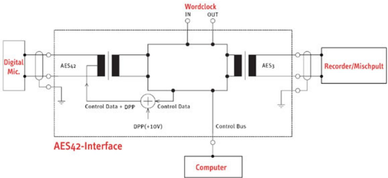
Um die Steuerdaten zu übertragen, moduliert man die Versorgungsspannung mit einer Modulationsspannung von zwei Volt. Bei einer Abtastrate von 48 kHz beträgt die Pulsrate des Signals maximal 9600 Bit pro Sekunde. Auf der Mikrofonseite wird der Wechselstromanteil vom Gleichstromanteil getrennt und die seriellen Daten können im Mikrofon ausgewertet werden.
