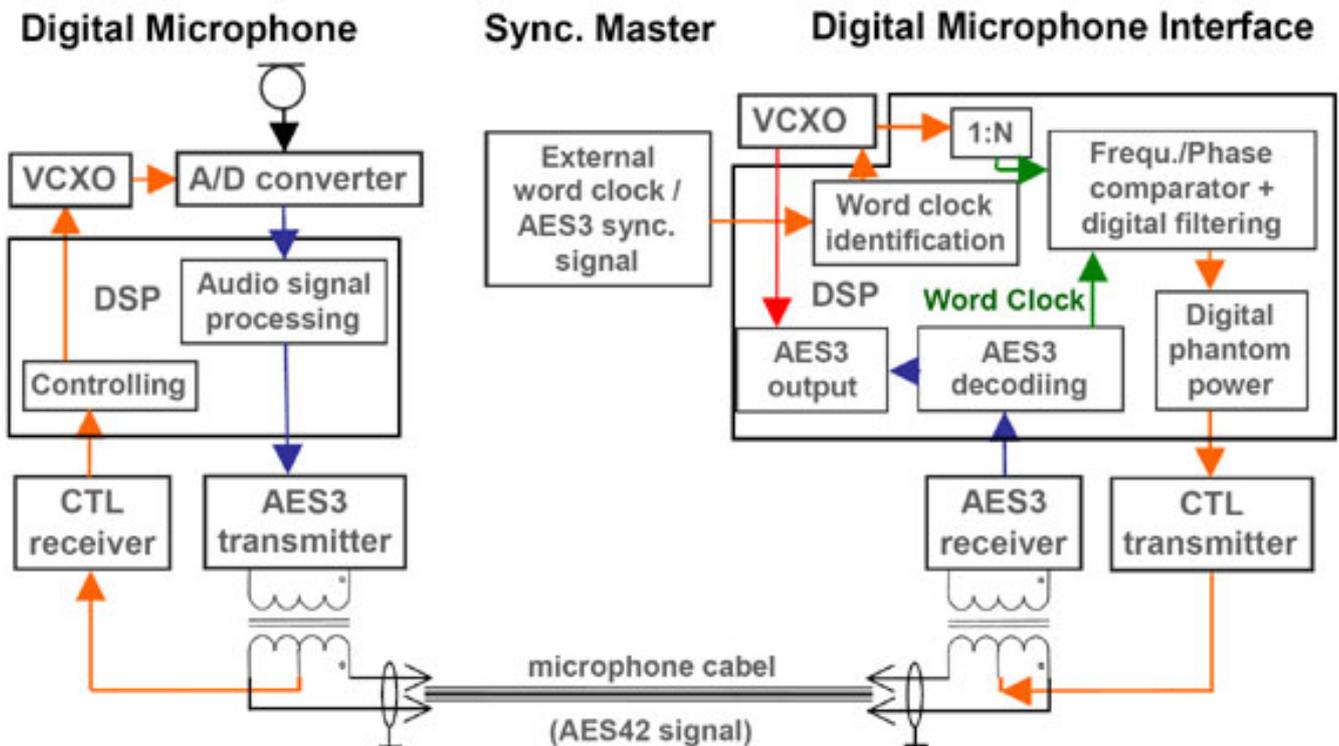
Es sind zwei Betriebsarten für eine Abtastratensynchronisation vorgesehen. Beim sogenannten "Mode 1" läuft der Taktgenerator im Mikrofon frei und daher ist auf
