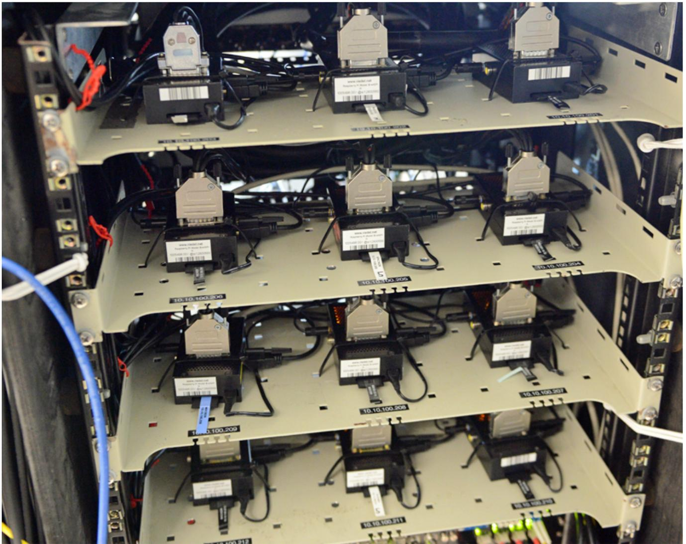
Raspberry Pi Minirechner (s. Abb. oben) werden genutzt, um bestimmte Audio/Video-Signale auszuspielen. Diese werden von der Intercom getriggert. Das Videosignal wird über HDMI ausgegeben.
