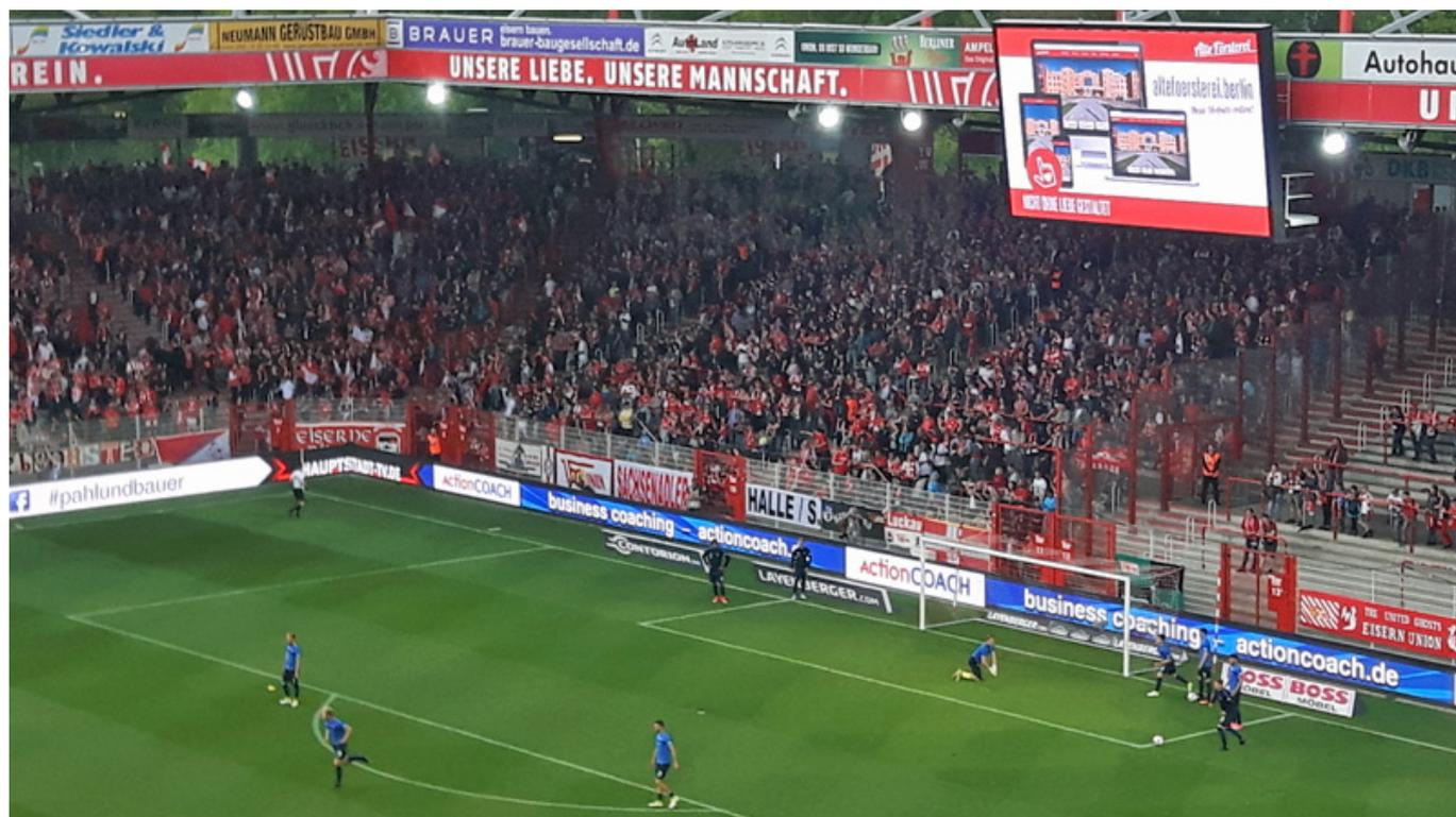
Im Juli 2016 wurde eine neue Anzeigetafel mit 1344 x 768 Bildpunkte und eine LED-Bande mit 265 Modulen (96 x 96 Bildpunkte) installiert. Anzeigetafel und LED-Bande wurden von der deutschen Firma prodesign Marketing GmbH aus Berlin produziert und die Projektleitung hatte Ulf Rohbeck. Beide Systeme arbeiten auf dem NovaStar Realtime Network Protocol. Die Ansteuerung beider Systeme erfolgt zentral aus der Regie und wurde voll in das bestehende System integriert.
