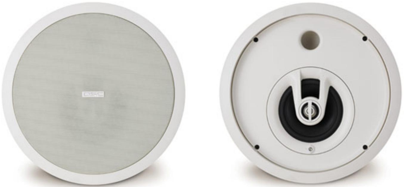
Als Deckenlautsprecher sind AD-CI52ST vorgesehen. Klanglich sind AD-S81H und Wandlautsprecher AD-CI52ST aufeinander abgestimmt. Die Zweiwegesysteme AD-CI52ST sind in einem Stahlgehäuse verbaut und mit einer Blende aus Polystyrol versehen. Der Basskanal ist mit einem 5,25"-Lautsprecher sowie einer 1"-Hochtonkalotte bestückt und bietet trotz seiner sehr flachen Bauweise ausreichendes Klangvolumen. Auch in sehr flachen Decken, wo Lüftungsanlagen eingebaut sind, lässt er sich noch einsetzen.
