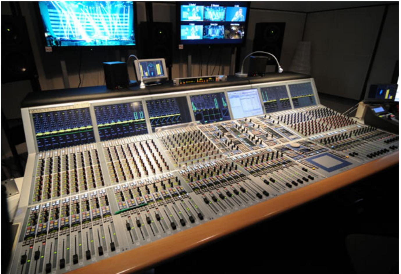
Alle vier Aurus-Pulte für den On-Air-Mix verfügten über jeweils 48 Faderzüge und sieben DSP-Einheiten. Die drei zusätzlich bereitgestellten Aurus Digitalpulte waren noch jeweils mit zwei NEXUS-Basisgeräten (6 und 12 HE) ausgestattet. Im Ü-Wagen sind sechs NEXUS-Basisgeräte vorhanden.
