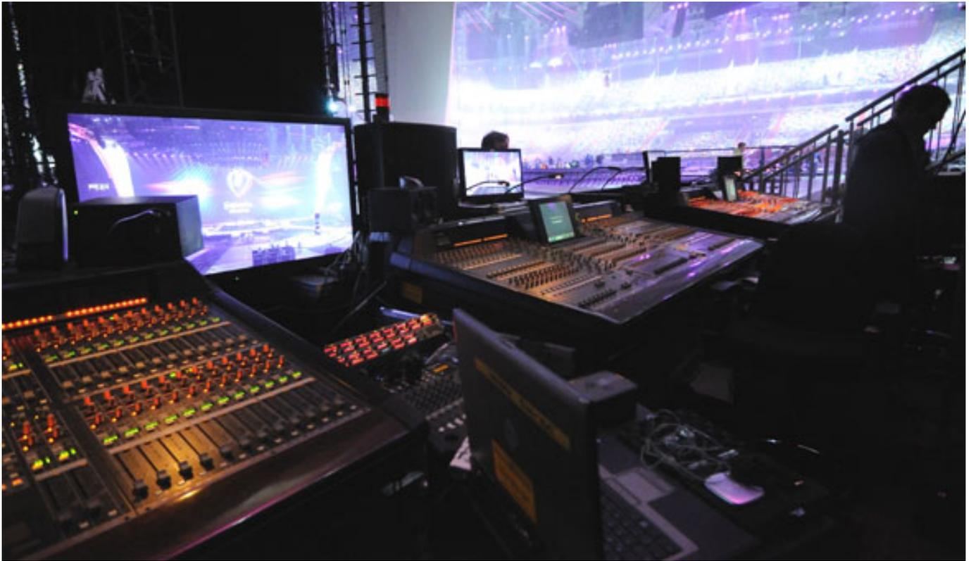
Drei weitere PM1D wurden für das Monitoring genutzt. Zwei für den Contest Monitor Mix auch im gespiegelten Modus. Ein PM1D sorgte für den Monitor-Sound der Opening und Intervall Acts. Das fünfte PM1D stand im In-Ear -Proberaum allen Künstlern zu Verfügung. Monitor Engineers waren Karim Hubatsch und Ravi Rai, den Proberaum betreute Stefan Tönnis.
