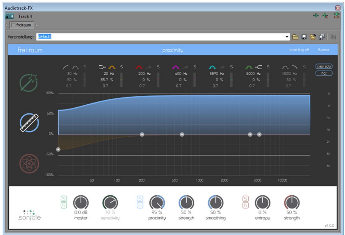
Über drei Regler lassen sich unten die drei frequenzunabhängige Parameter "proximity" für die Direktheit, "strength" für die Stärke der dem Direktschall zugeordneten Anteile und "smoothing" für die Glättungsstärke des Berechnungsergebnisses. Für eine maximale Enthaltung eines Signals wäre proximity also auf 100 %, strength auf 100 % und smoothing auf 0 % einzustellen.
