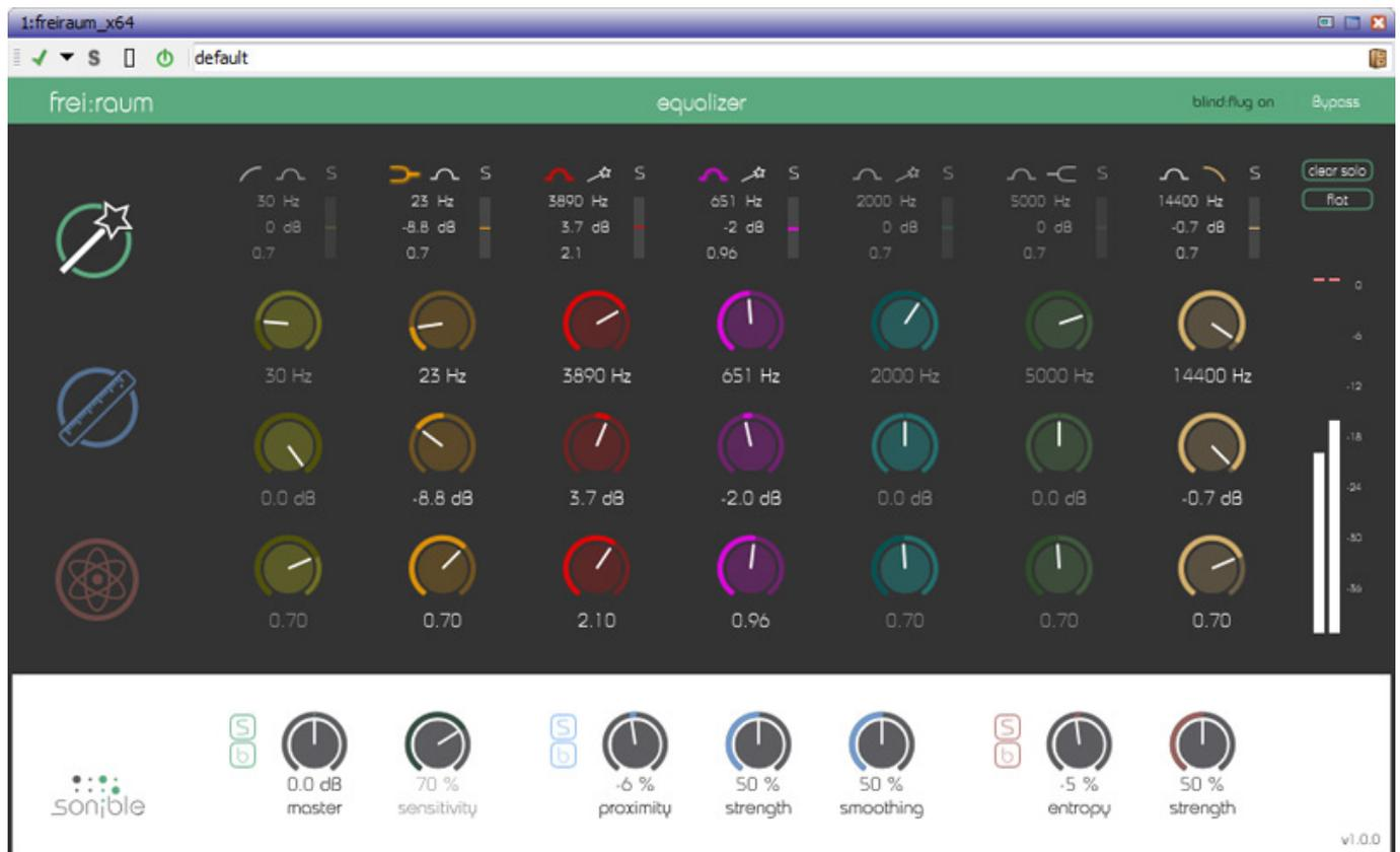
Durch Anklicken des oberen Icons lässt sich ein phasenlinearer Siebenband-Equalizer aufrufen (Abb. hier oben in der Bedienvariante mit Reglern). Über die grafische Darstellung der Frequenzübertragungsfunktion oder über die drei Regler pro Band, lassen sich so Arbeits- bzw. Grenzfrequenz, Gain und Filtergüte einstellen. Soweit der klassische Equalizer-Betrieb.
