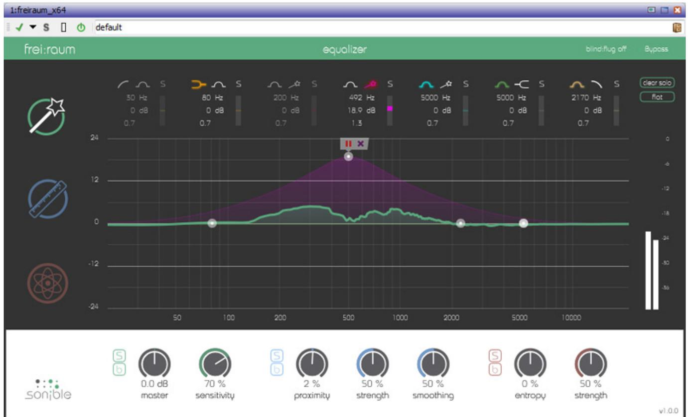
Ganz unten links gibt es noch die zwei Regler. Mit "master" kann man den Pegel anpassen und mit "sensitivity" kann man die Empfindlichkeit der Smart-Bänder einstellen. Umso höher dieser Wert umso höher wird auch eine homogene Energieverteilung angestrebt.
